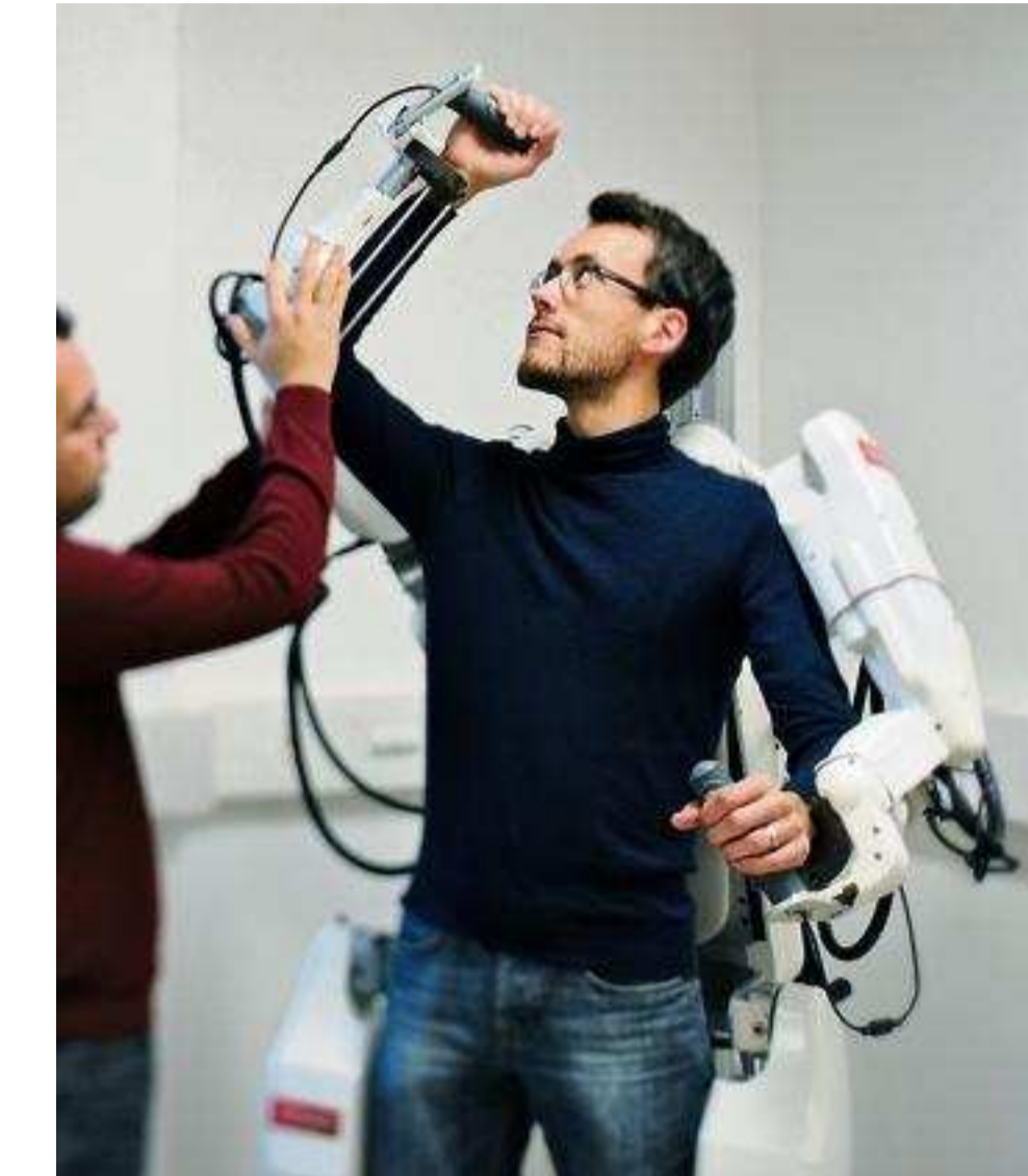
Equipé de 14 moteurs qui roulent et déroulent des câbles pour permettre de bouger bras et jambes, l'exosquelette, ici en phase de test, pèse 60 kg. A. AUBERT/CEA
